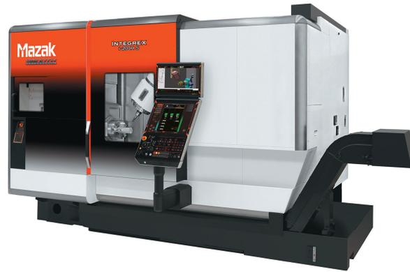
2 Eine 'Integrex i-250H ST' ist auf der AMB mit einer hydraulischen Lünette auf der unteren Revolverscheibe ausgestattet, die optimal für komplexe Wellenbearbeitungen geeignet ist
